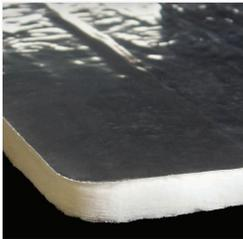
**PYROGEL:** Pyrogel® XT-E es una manta de aislamiento para altas temperaturas **hasta mas 650 °C**, formada de Aerogel de sílice y reforzada con relleno de fibra de vidrio no tejida que posee el mas bajo Coeficiente de Conductividad Térmica en el mercado. Evita Corrosión Bajo Aislación, NO absorbe agua y es Barrera contra el Fuego.
